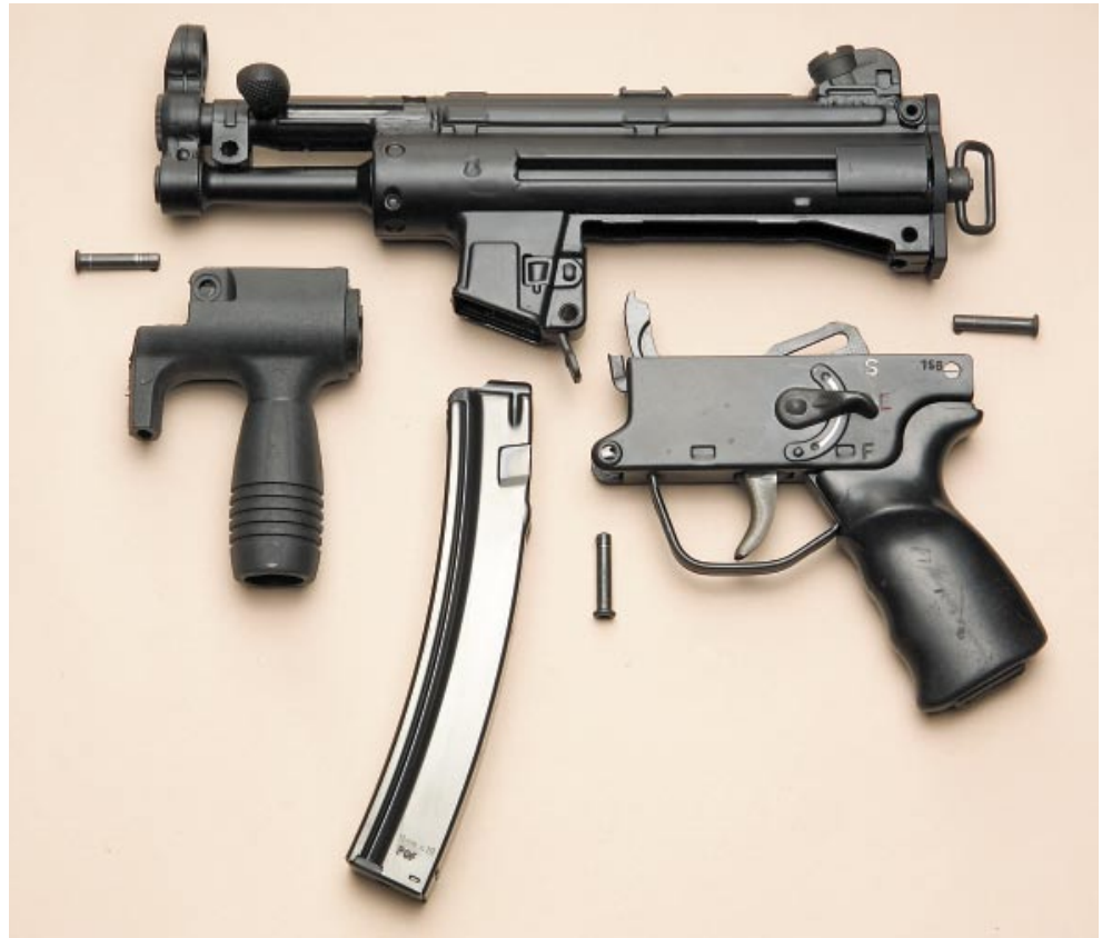
Teilesatz. Zerlegt offenbart sich, wie kurz das Stummelläufchen tatsächlich ist. Wird ein Vorderschaft ohne Handgriff verwendet, ist die Waffe sogar zum sportlichen Schießen zugelassen.
